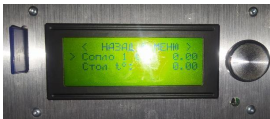
Рисунок 9 – Установка температуры экструзии и рабочей платформы с помощью панели настройки 3D принтера Prism Special
