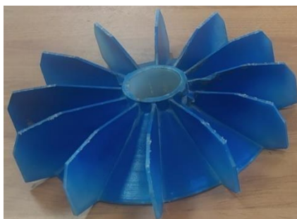
Рисунок 4 - Крыльчатка вентилятора охлаждения электродвигателя
